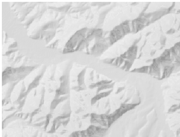
Rys. 6. Przykładowe zobrazowanie danych wysokościowych zapisanych w formacie DTED, poziom 2
